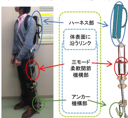
三モードバネ機構を用いた姿勢アシスト装置
