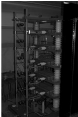
図1 インパルス電圧発生装置 (本体)
