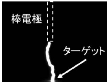
図4 撮影されたインパルス放電発光の例 (電極とターゲット間の距離 5cm)
