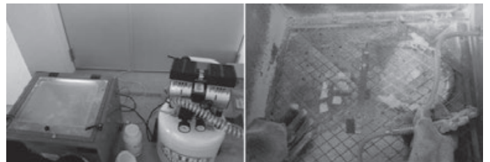
図3 砂粒衝突試験装置の外観と内観。
