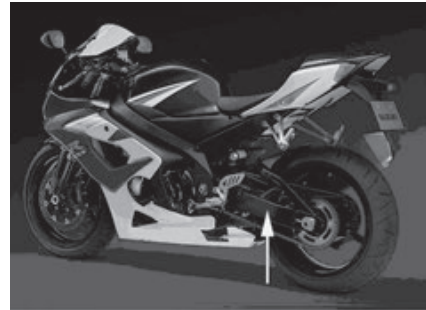
図1 オンロードタイプのモーターバイク (矢印部分がスイングアーム)
