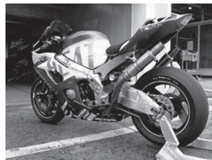
図 6 改良型スイングアームを装着したレーシングバイク
