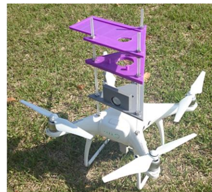
(b) 光学系をドローンに設置した様子
