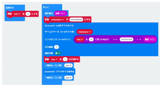
図 2 micro bit と BLE プログラム例
