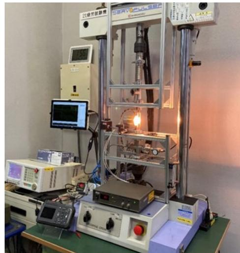
図5 構築したスラスタ耐久性評価装置
