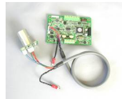
<サーモパイルを使用した『非接触温度センサー』と『炭酸ガスセンサー』の例
