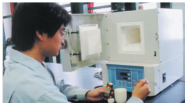
電気炉による試料の調製
