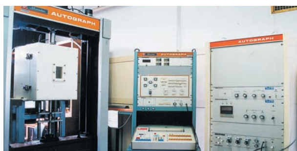
材料強度試験機 Machinery for performing a load test on materials コンピューターを導入し、引張荷重を制御する Introduction of computers to control to mile load.
