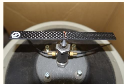
CFRPの中央加振試験の様子
