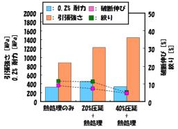
熱処理しただけでも脆くなる傾向がありましたが、ひずみを入れた後に熱処理を施すと引張強さはさらに増加して、破断伸びは低下しました。これは、ひずみが材料を脆くしていることを示しています。
