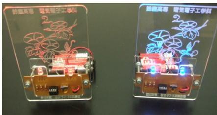
PICでLEDの光を制御する電子回路
