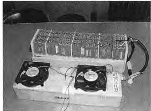
図6 組電池化されたリチウムイオン二次電池の一部
