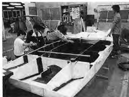
図2 DEVeL4号機のカウル製作風景
