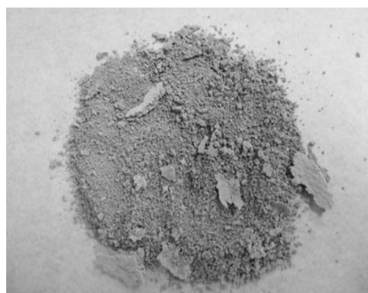
図3 加熱混練法で調製した PVC-ZnO (R=1.6)
