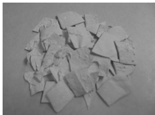
図2 薄膜法で調製した PVC-ZnO (R=6)
