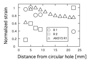
図6 円孔からの距離とひずみの関係( $\theta=0$ )
