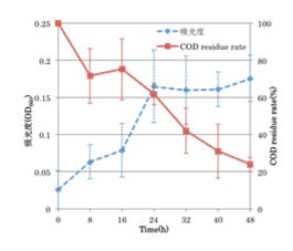
図4 MU11 での平均 COD 残存率と平均吸光度 の経時変化
