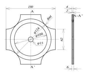
図2 平面二軸引張試験片
