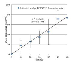
図2 活性汚泥による COD 分解率経時変化
