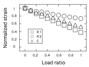
図5 荷重比とひずみの関係( $\theta=\pi/2$ )
