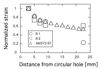
図7 円孔からの距離とひずみの関係( $\theta=\pi/2$ )
