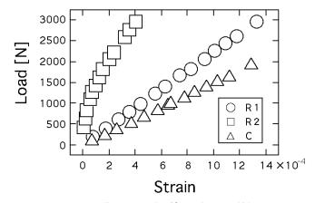
図3 荷重-ひずみ線図 (円孔近傍)
