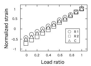
図4 荷重比とひずみの関係( $\theta=0$ )
