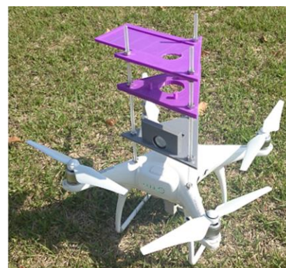
(b) 光学系をドローンに設置した様子
