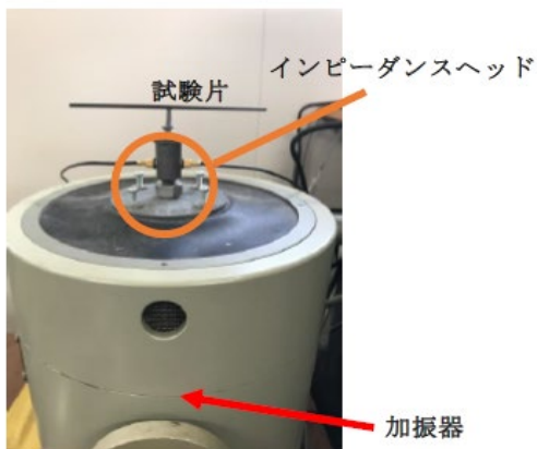
図 5 中央加振法の試験装置
