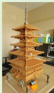
自作加振器による五重塔の振動特性評価
